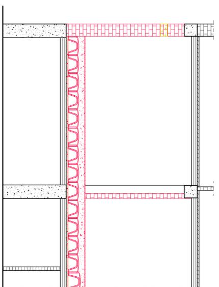
SEZIONE C-C - DEMOLIZIONI E RICOSTRUZIONI - 1:50
